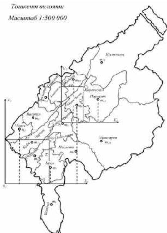
Рис. 3. Схема определения координат точки C рационального месторасположения сервисного центра по правилу «Условный центр тяжести»
