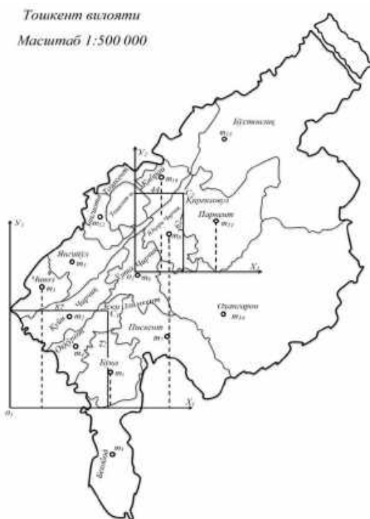
3-расм. Сервис маркази рационал жойлашадиган С нуқтанинг координаталарини “Шартли оғирлик маркази” қоидаси билан аниқлаш схемаси
