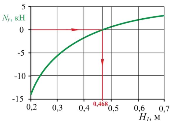
**Рис.4. График изменения  $N_y$  в зависимости  $H_1$**
