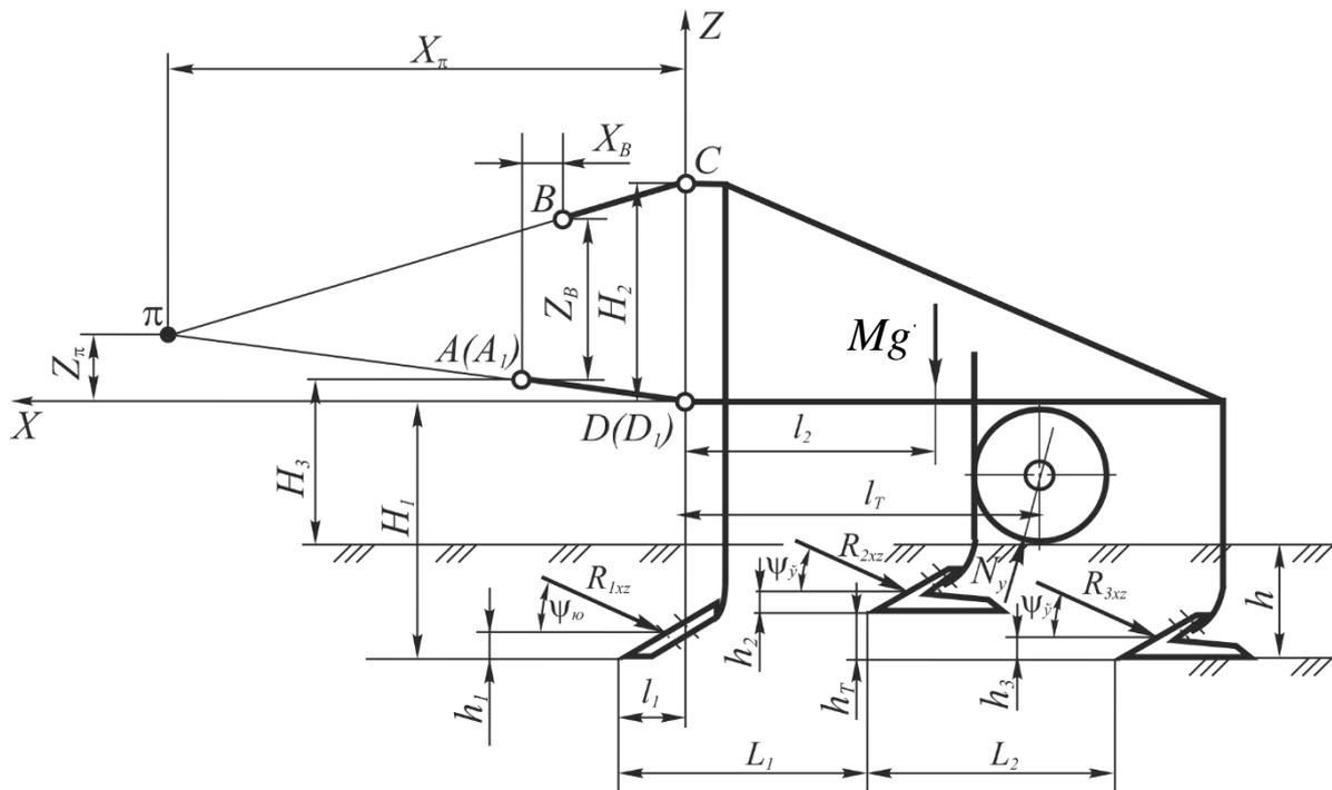
**Рис.3. Схема к определению общей силы реакции на опорные колеса усовершенствованного чизель-культиватора**
