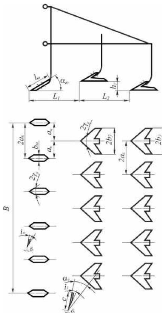
**Рис.2. Взаимное размещение рабочих органов усовершенствованного чизель-культиватора и его основные параметры**
