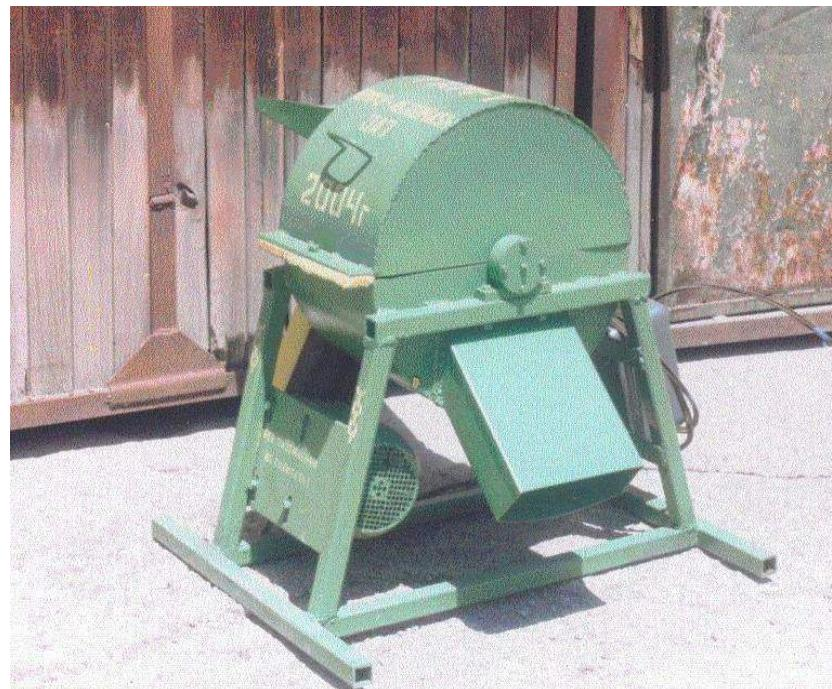
**Назначение:** Устройство предназначено для измельчения листостебельной массы грубого корма, для корма животных. Рабочий орган устройства состоит из молотковой дробилки.
