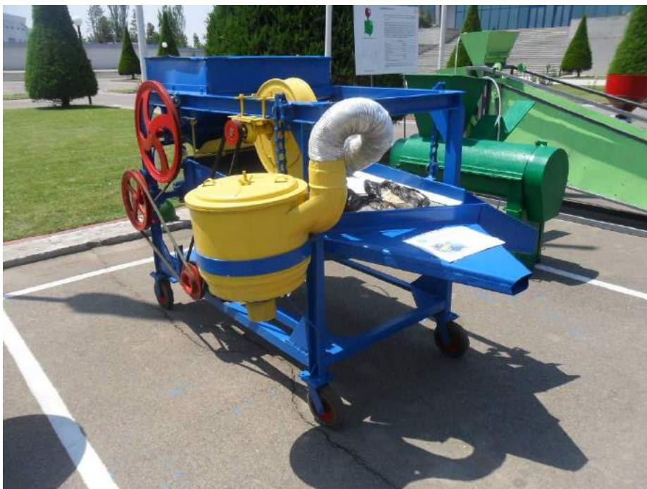
**Назначение:** Устройство предназначено для очистки зерновой массы от крупных и мелких примесей. Она состоит из бункера, всасывающего трубопровода, вентилятора, верхнего и нижнего решет, колебателя.
