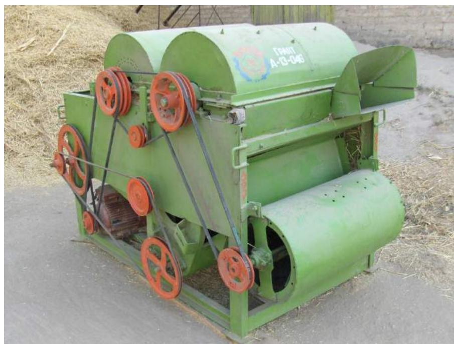
**Назначение:** Молотилка предназначена для обмолота зерновых культур и состоит из рамы, подающего лотка, роторного молотильно-сепарирующего устройства тангенциального типа, вентилятора, решета и механизма выгрузки зерна. Молотилка применяется на мелкоконтурных полях фермерских и дехканских хозяйств, при обмолоте хлебной массы зерновых культур, убранных при восковой спелости с дозреванием их на стационаре.
