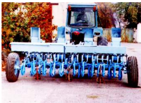
Комбинированная машина для корчевания, измельчения стеблей хлопчатника и сева пшеницы
