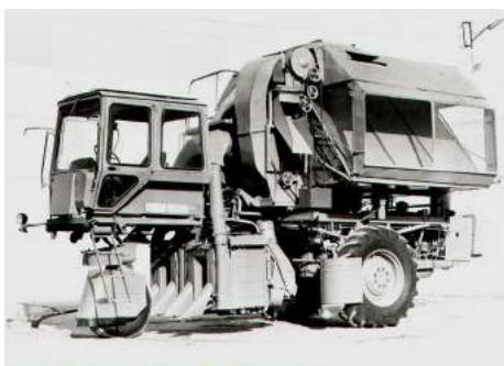
Хлопкоуборочная машина с пневмоподборщиком ХНП-1,8
