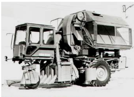
Хлопкоуборочная машина с пневмоподборщиком ХНП-1,8
