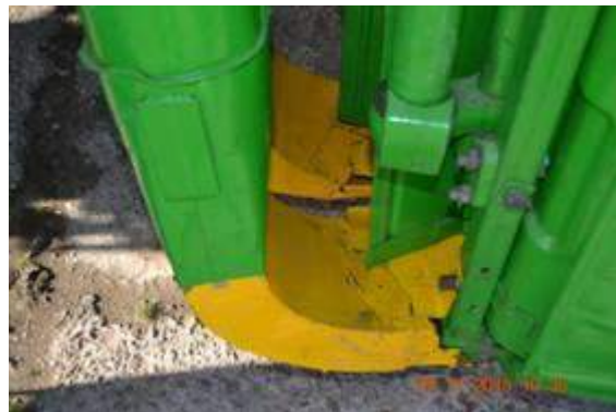
Пахта туткич мосламасининг макет нусхаси терим аппаратига ўрнатилган
